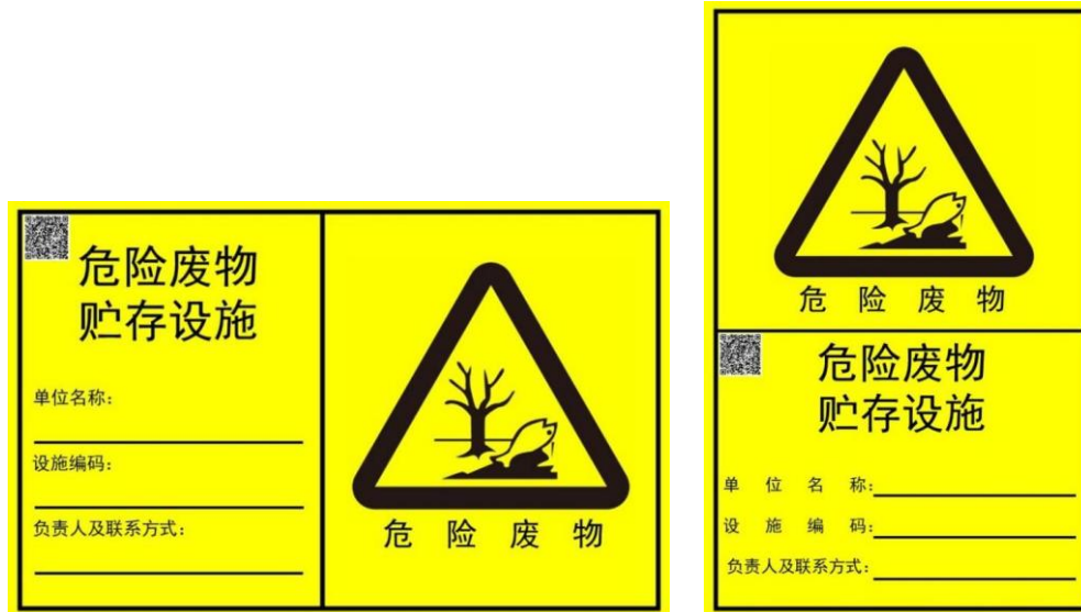
图 4-2 危险废物贮存设施标识
